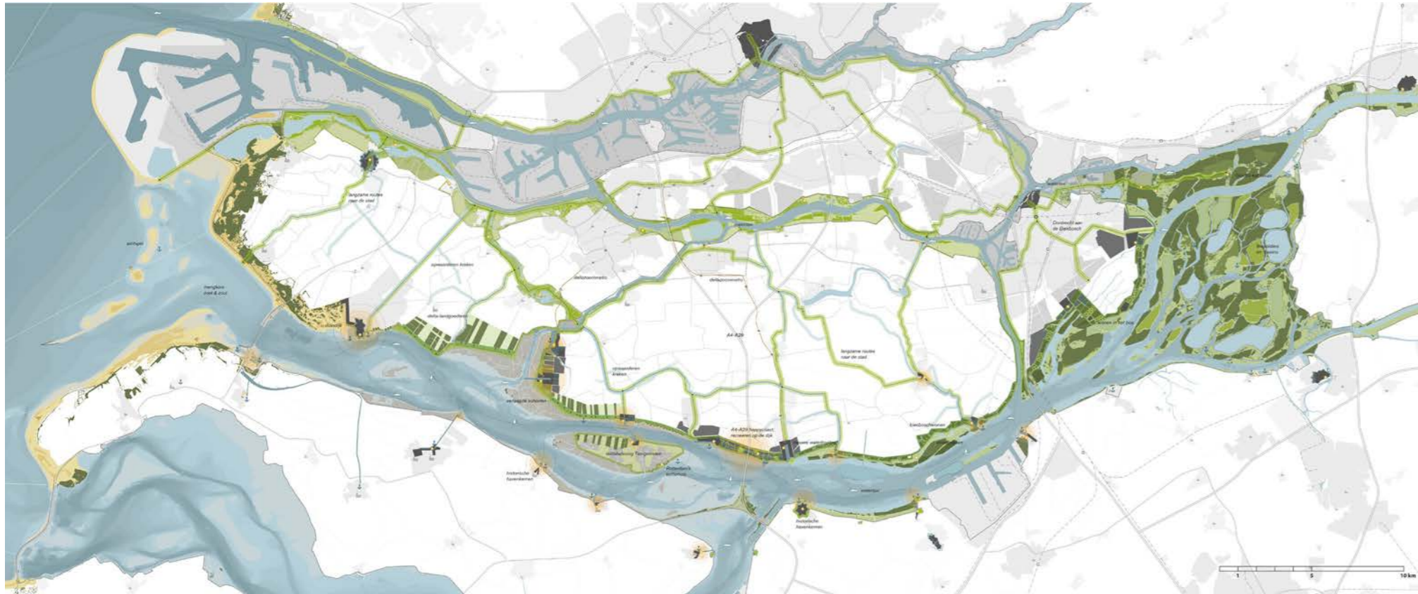
De studie 'De Grote Deltazoom' van BoschSlabbers schetst een landschappelijke aanpak van de dijkversterkingen langs het Haringvliet en het Hollands Diep met o.a. bewoonbare superdijken en nieuwe duinenrijen in de voordelta (beeld: BoschSlabbers Landschapsarchitecten, 2012).
